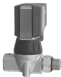
GEMÜ 8303 3/2-ходовый вспомогательный управляющий клапан с пря- мым управлением из латуни или нержавеющей стали, DN 2 (1,0–10 бар)
