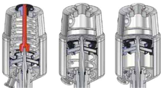
Привод, функция управ-Привод, функция управ-Привод, функция управ- ления 1 ления 2 ления 3 нормально закрытый нормально открытый управление в двух пружиной (NC) пружиной (NO) направлениях (DA)
