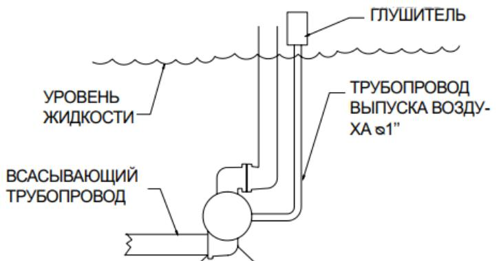
Погружное применение насоса возможно, если материалы, из которых он изготовлен, совместимы с перекачиваемой жидкостью. Труба для выпуска воздуха должна располагаться выше уровня жидкости. Если источник перекачиваемого продукта располагается выше уровня насоса (такое расположение используется при заливе всасывающей линии), для предотвращения сифонирования трубы выпуска воздуха следует установить выше уровня источника жидкости.
