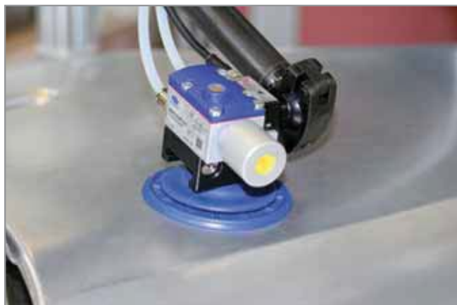
Децентрализованная система с использованием эжектора SEAC RP в комбинации с вакуумной присоской
