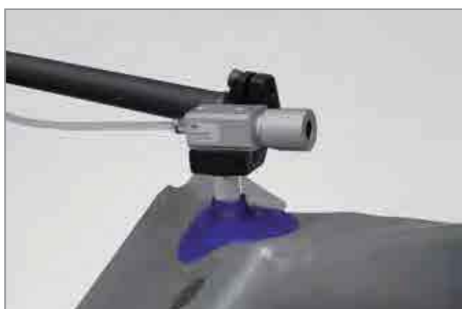
Децентрализованная система с использованием эжекторов SEAC ECO в комбинации с вакуумными присосками
