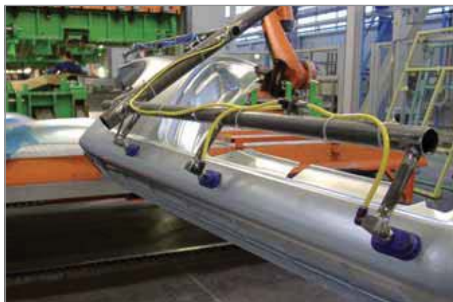
Сильфонные присоски SAOB используются для перемещения кузовных элементов
