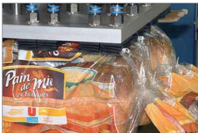
Сильфонные вакуумные присоски FSGB-R используются для перемещения упаковочных материалов
