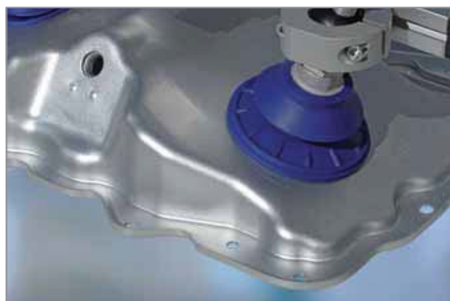
Сильфонная присоска SAB используется для перемещения частей кузова автомобиля
