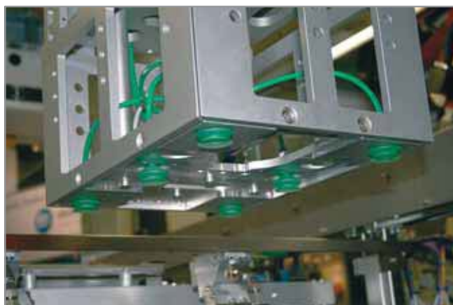
Сильфонные вакуумные присоски SPB1 в упаковочной машине с вертикальной загрузкой
