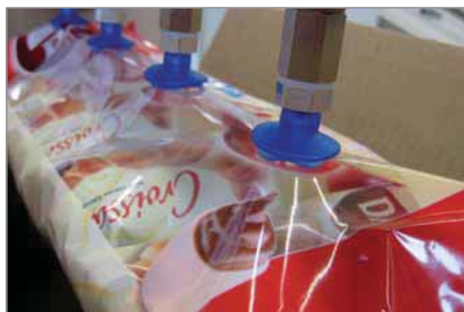
Сильфонные вакуумные присоски FGA PVC используются для перемещения гибкой упаковки
