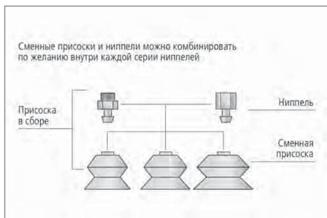
Конструкция сильфонных вакуумных присосок FGA PVC (1.5 гофра)
