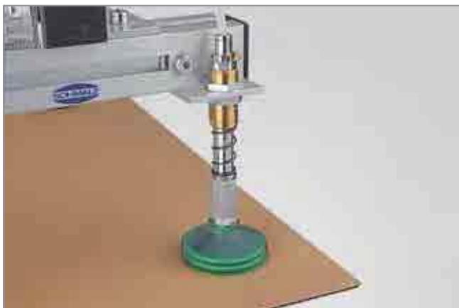
Пример монтажа пружинного плунжера FSTE
