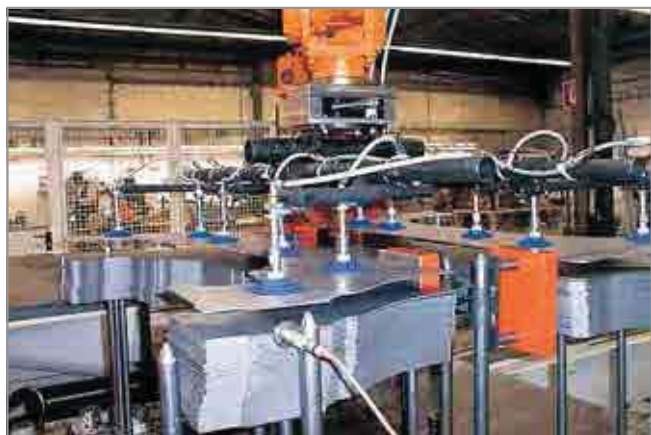
Пример монтажа пружинных плунжеров FSTE-HD
