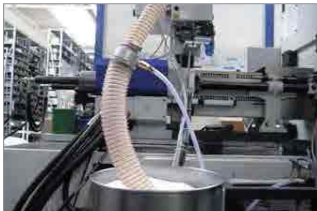
Транспортировка гранул при помощи подающего эжектора SEC
