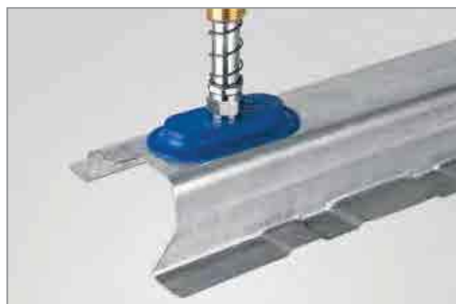
Плоская присоска SAOF используется для перемещения штампованной металлической детали
