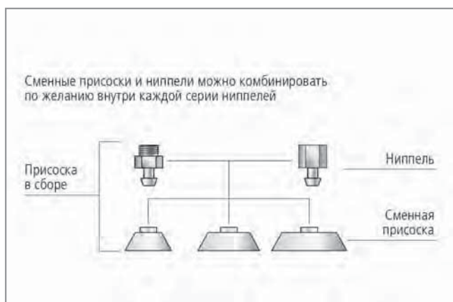
Конструкция плоских вакуумных присосок SHFN
