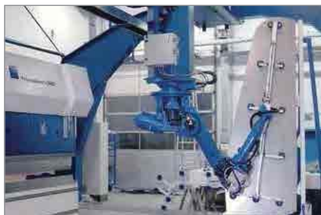
Плоские вакуумные присоски SAF используются для перемещения металлических частей
