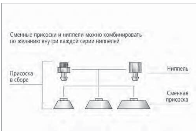
Конструкция плоских вакуумных присосок PFYN
