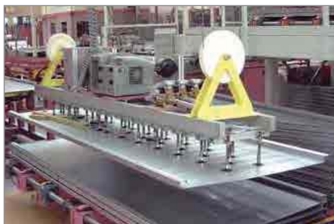
Плоские вакуумные присоски PFYN VU1 используются для перемещения больших изделий из листового металла
