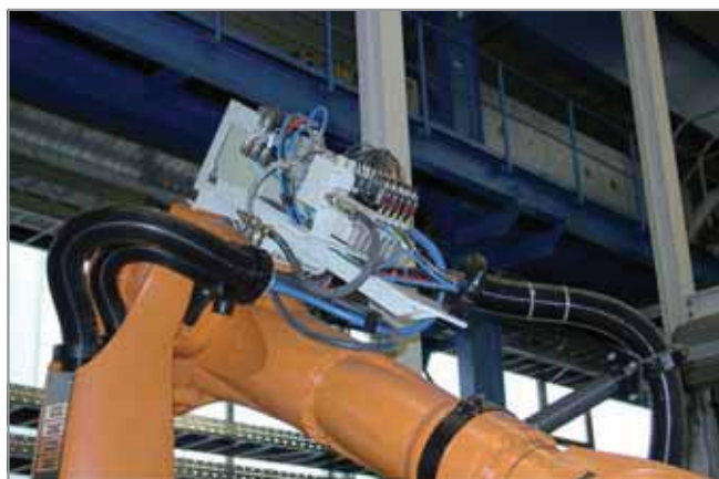
Централизованная система с использованием многофункциональных эжекторов SMP
