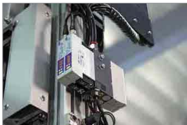
Централизованная система с использованием многофункциональных эжекторов SMPi
