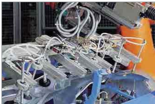
Централизованная система с использованием многофункциональных эжекторов SCP для перемещения частей кузова автомобиля
