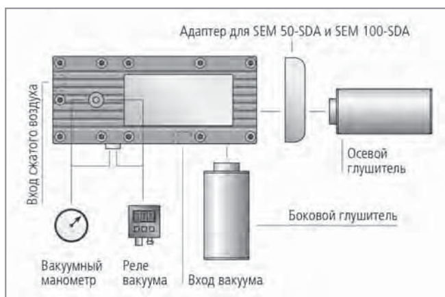
Конструкция многоступенчатых эжекторов SEM
