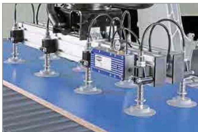
Централизованная система с использованием многоступенчатого эжектора SEM для перемещения древесных плит с покрытием
