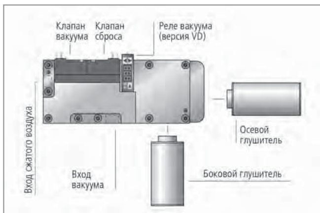
Конструкция многоступенчатых эжекторов SEM-C с дополнительными функциями
