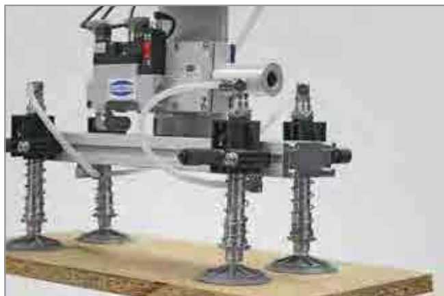
Централизованная система с использованием многоступенчатого эжектора SEM-C для перемещения ДСП
