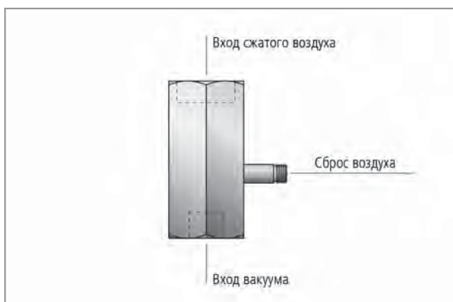
Конструкция линейных эжекторов VR
