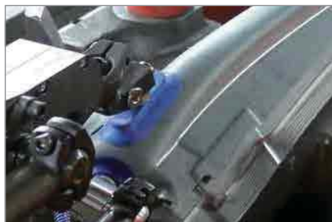
Колоколообразная вакуумная присоска SAOG используется для переноса сильно изогнутых металлических частей
