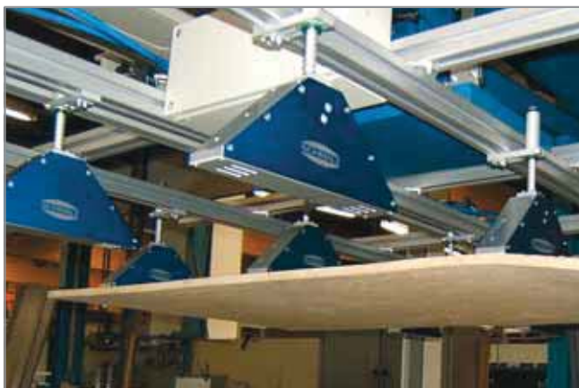
Игольчатые захваты SNG-D используются для перемещения диэлектрических матов
