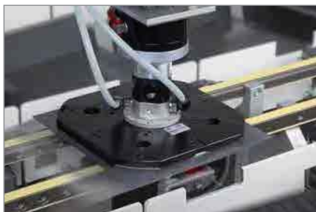
Захват SWGm используется для перемещения фотоэлементов
