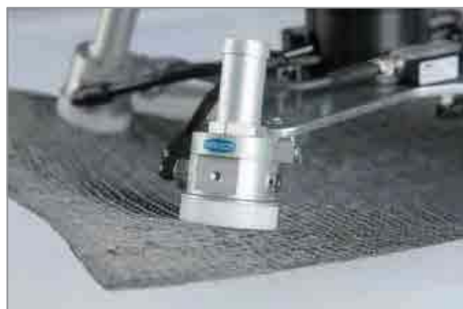
Захваты SCG используются для перемещения композитных материалов
