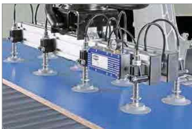
Вакуумные присоски SPU используются для перемещения облицованной ДСП
