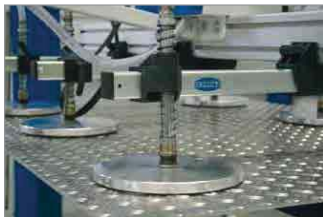
Вакуумные присоски SPK используются для перемещения рифленого металлического листа
