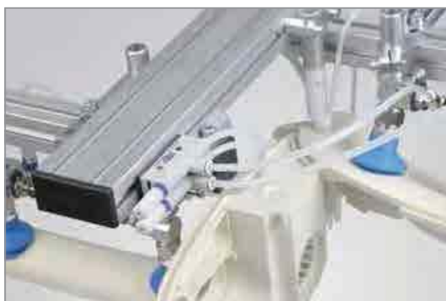
Базовые эжекторы SBP в составе захвата для извлечения пластиковых деталей из машины для литья под давлением
