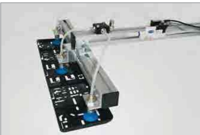
Централизованная подача вакуума с использованием базового эжектора SBP-C для перемещения пластикового изделия
