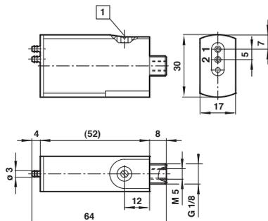
1 Регулировочный винт
