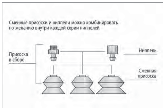
Конструкция сильфонных присосок FSGB (3.5 гофра)
