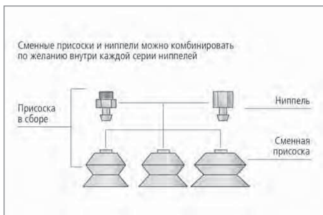
Конструкция сильфонных вакуумных присосок FSGA VU1 (1.5 гофра)
