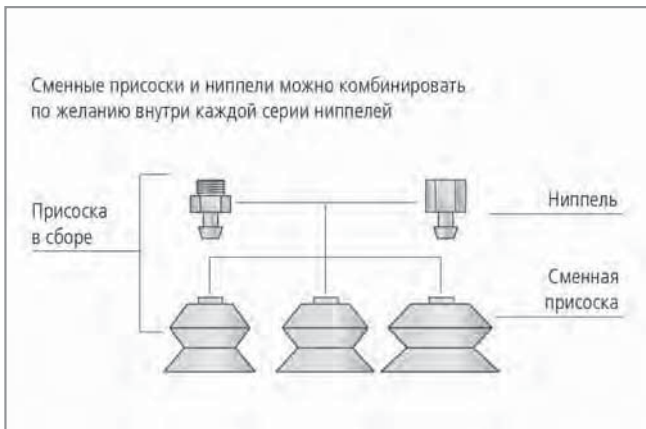
Конструкция сильфонных присосок FSGA (1.5 гофра)
