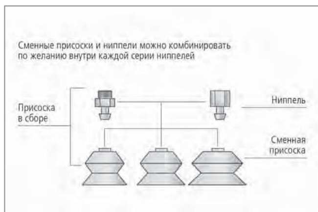
Конструкция сильфонных присосок FSG VU1 (2.5 гофра)
