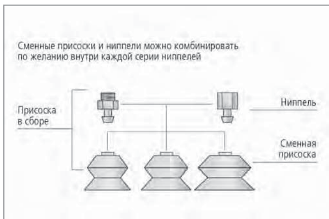
Конструкция сильфонных присосок FSG (2.5 гофра)
