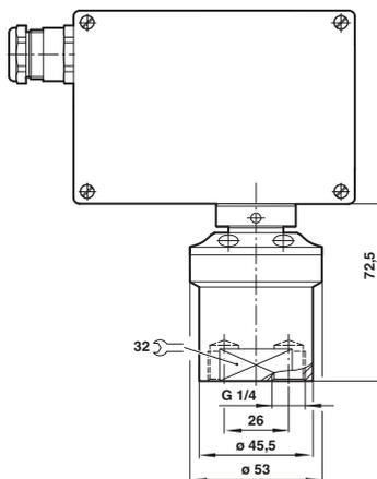
Электрическое соединение M20 x 1,5 соответствует DIN 46320
